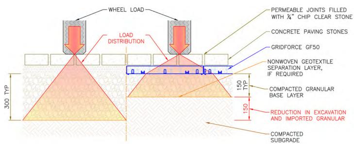
**DRIVECEL GF50 HEAVY DUTY - LOAD DISTRIBUTION**
